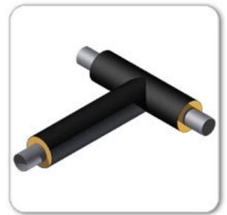
**Le DHEC** est une pièce thermorétractable en polyoléfines réticulées. Le DHEC a été développé pour réaliser l'étanchéité de la tranche d'isolation en mousse de polyuréthane entre le tube caloporteur et la gaine extérieure, sur les réseaux de tubes pré-isolés.
