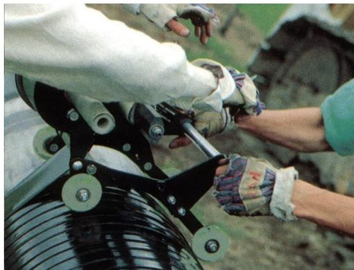
La Machine se compose de 2 supports en aluminium (S1-S2) sur lesquels sont fixées les roues ® qui vont permettre à la machine de rouler sur le tuyau lors de l'opération d'enrobage.
