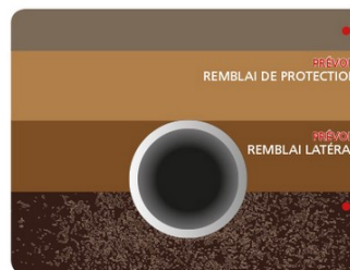
Canalisation seule POSE TRADITIONNELLE
