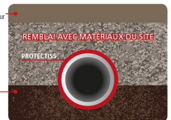
Canalisation + géotextile POSE AVEC PROTECTISS
