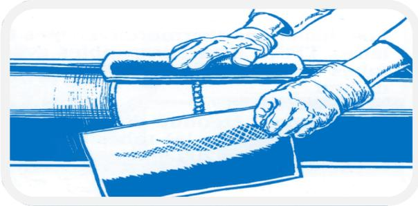
Retirer la pellicule de protection sur environ 150 mm à partir de l'extrémité du manchon prête à monter. Centrer le manchon sur la soudure à protéger, perpendiculairement à l'axe du tube.
