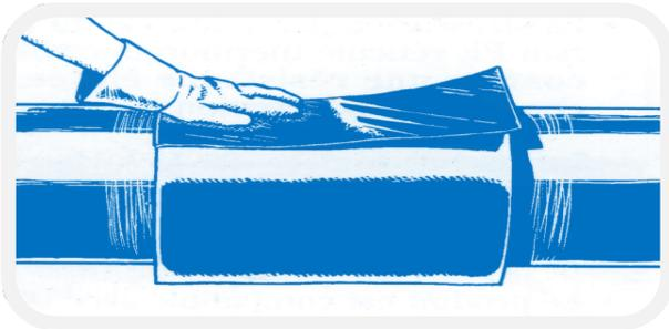
Le recouvrement doit être réalisé dans le tiers supérieur du tube, là où il sera facilement accessible. Si la température ambiante est plutôt basse, il est recommandé de réchauffer légèrement l'intérieur des extrémités devant être superposées ainsi que la pièce de fermeture.
