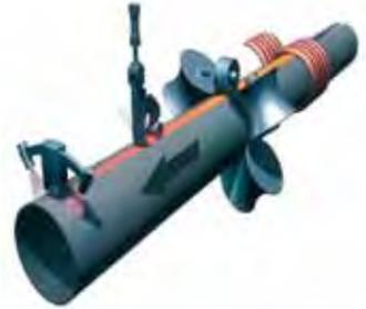
**Pour les tubes → au DN600**: Soudage hélicoïdal à l'arc (SAW)
