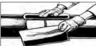
Retirer la pellicule de protection sur environ 150 mm à partir de l'extrémité du manchon prête à monter. Centrer le manchon sur la soudure à protéger, perpendiculairement à l'axe du tube. Le manchon doit recouvrir d'au moins 50 mm, de part et d'autre le revêtement posé en usine. L'enrouler.
