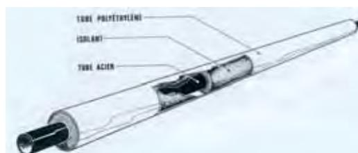
**Domaine d'application:** Transport des fluides couramment utilisés ( eau potable, eau usée, eau sanitaire, condensats noyés, eau glacée, eau glycolée) Température maxi en service continu: +148°C
