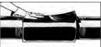
Le recouvrement doit être réalisé dans le tiers supérieur du tube, là où il sera facilement accessible. Si la température ambiante est plutôt basse, il est recommandé de réchauffer légèrement l'intérieur des extrémités devant être superposées ainsi que la pièce de fermeture.
